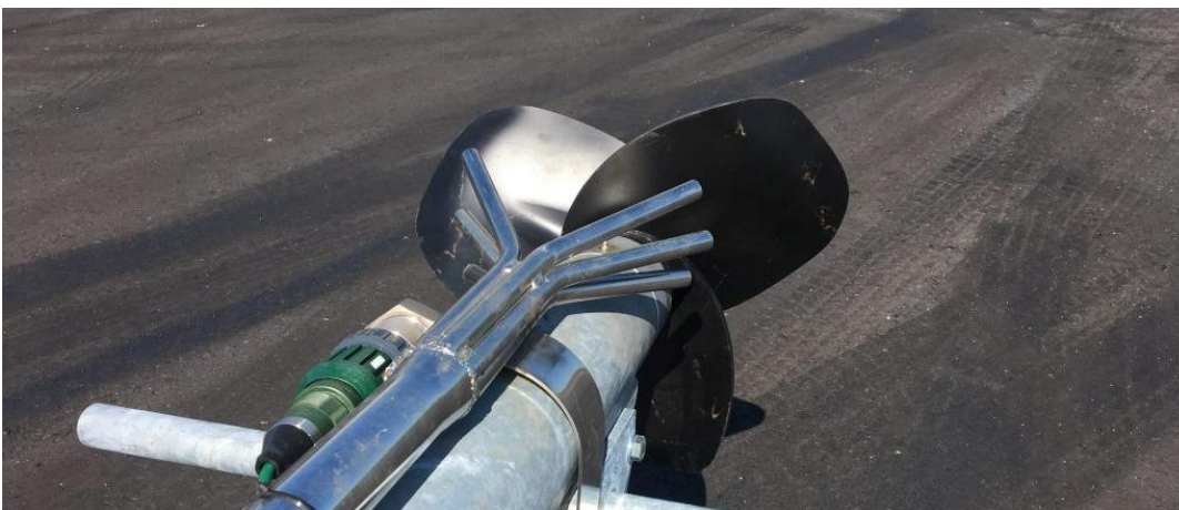
Øverum slurryblander, hvor doseringen af syre er delt op i 4 individuelle rør og med en pH-sensor monteret ovenpå for at overvåge slurry-pH
