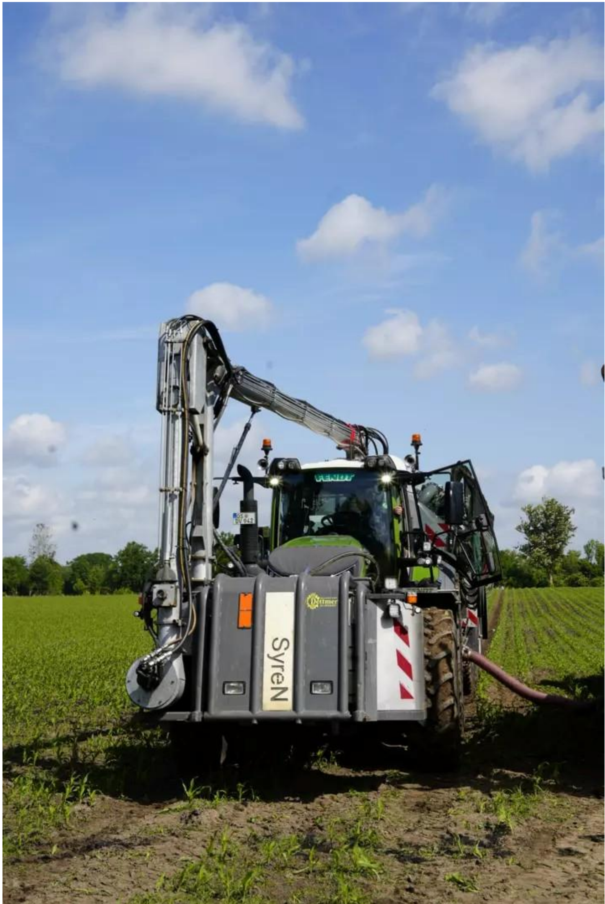
Der Schwefelsäure-Container wird gut geschützt in der Fronthydraulik mitgeführt. (Bildquelle: Lillie, Landwirtschaftsverlag GmbH)
