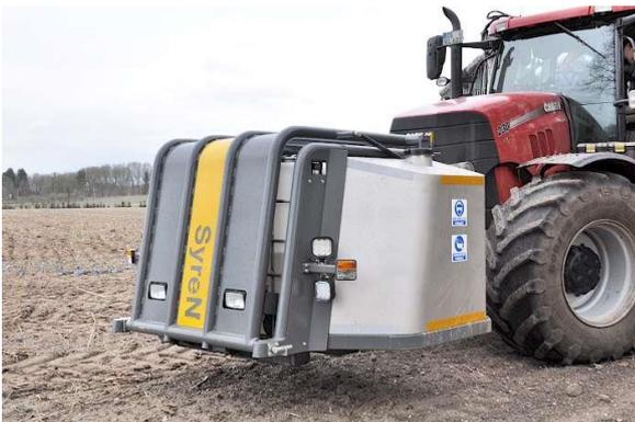
Mitgeführt wird die Schwefelsäure in einem speziellen Container in der Front. Die Zumischung der Schwefelsäure geschieht unmittelbar vorm Verteilergestänge. Ein Sensor misst den pH-Wert des Substrates am Gestänge nach Zumischung und justiert gegebenenfalls nach.
