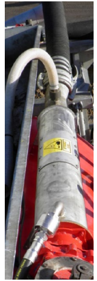
Säure-Injektor mit statischem Mischer
