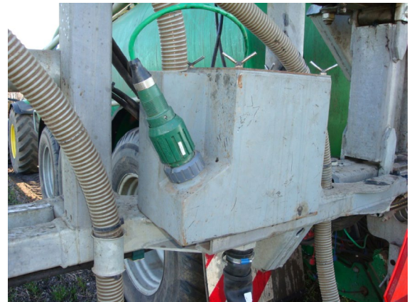
Güllesumpf mit pH-Sensor
