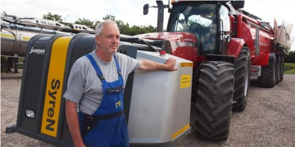
Jens Kirk foran SyreN-anlægget, som er monteret i frontliften på traktoren. Han købte anlægget til sæsonen 2001 sammen med en ny AP gyllevogn på 35 kubikmeter.
