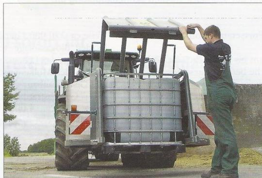
Zur Aufnahme der Schwefelsäure wird der stabile Bügel aufgeklappt.
