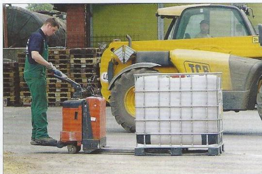
Stabil, sicher und leicht zu handhaben sind die nachfüllbaren IBC-Behälter, in denen die Schwefelsäure angeliefert wird.
