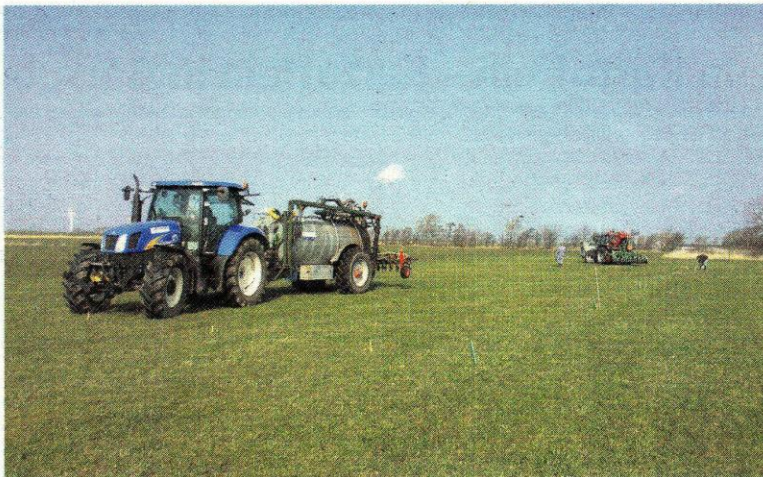
Bild 2: Parzellenversuche zur Ausbringungstechnik von Rindergülle in einer Kalkmarsch Nordfrieslands im Jahr 2011, links Ansäuerungssystem, rechts Injektion. Foto: Thorkild Birkmose
