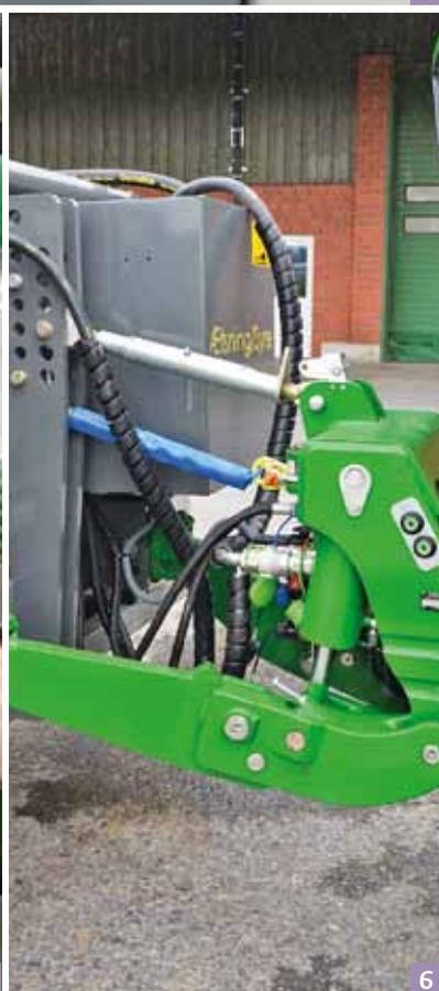
1, 2 Der Schwefelsäure-Container sitzt im Einsatz gut geschützt hinter einer verschlossenen Metallbox. Ist diese geöffnet, kann der Container bequem mit einer Palettengabel ausgetauscht werden.
