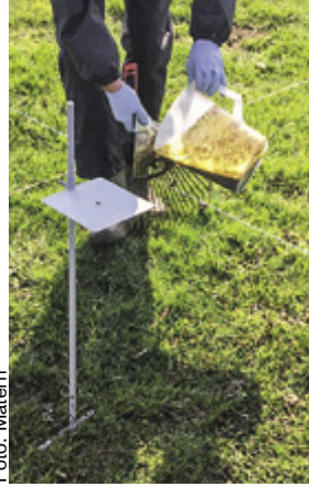
◁ Mit einem Rechen simulierten die Forscher einen Breitverteiler.
