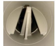
*Säure-Injektor mit statischem Mischer*
