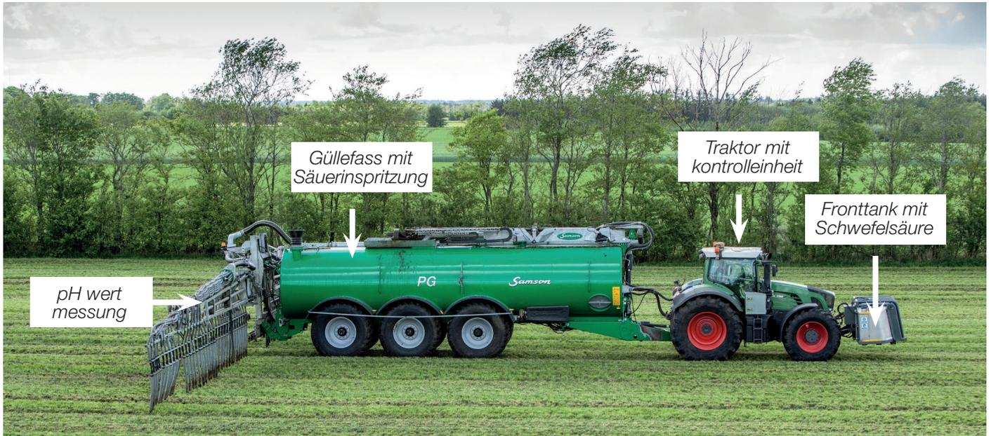
Der Fronttank vorne am Traktor enthält Tanks für Schwefelsäure, Additive und Wasser. Das System besitzt einen hydraulischen Antrieb für die Säurepumpe und eine Technikbox mit Strom und Elektronik zur Steuerung des Systems.
