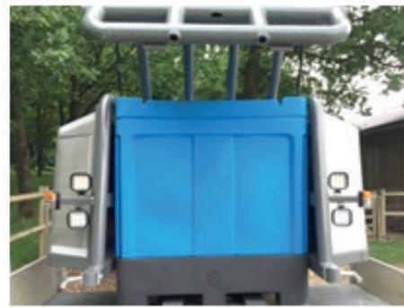
*Platz für einen IBC Tank mit ein „Tank-im-Tank“-Prinzip, das eine gesetzlich zugelassene Lagerung von Säure möglich macht ohne besondere Absicherungen gegen ein Überlaufen. Damit erhöhen sich Sicherheit und Flexibilität bei Transport und Lagerung*
