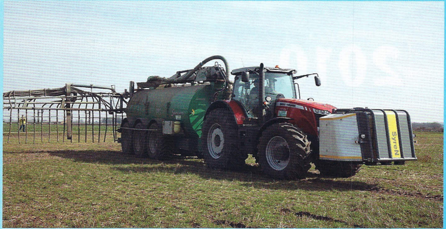
Udstyret i marken, hvor kapaciteten er langt højere med slangebom end ved brug af nedfælder. Der opstår heller ikke køreskader i samme omfang ved brug af bom frem for nedfælder.
