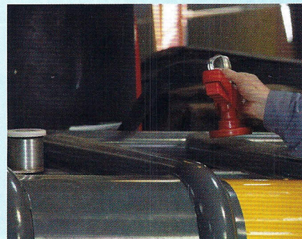
Her er vist en af de tørkoblinger, der bruges på palletanken. På den måde kommer man ikke i berøring med den stærkt ætsende syre.
