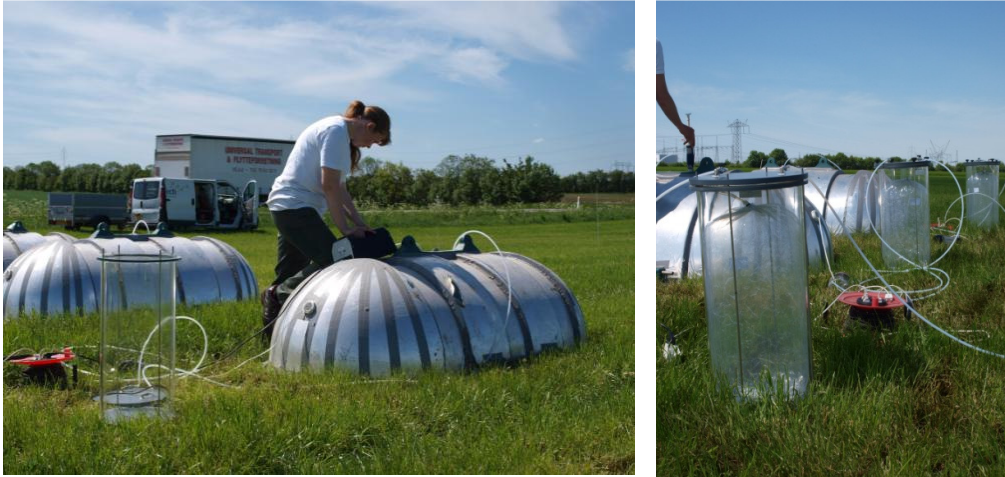
Figur 1 Udstyr til bestemmelse af lugtkoncentration over den udbragte gylle. Til venstre ses tre statiske lugtkamre som placeres over den udlagte gylle for at opkoncentrere lugtstofferne i luften over den udbragte gylle. Til højre ses vakuumbeholdere til udtagning af 30 liter luftprøver til olfaktometrisk bestemmelse af lugtkoncentrationer. Foto: Agrotech.
