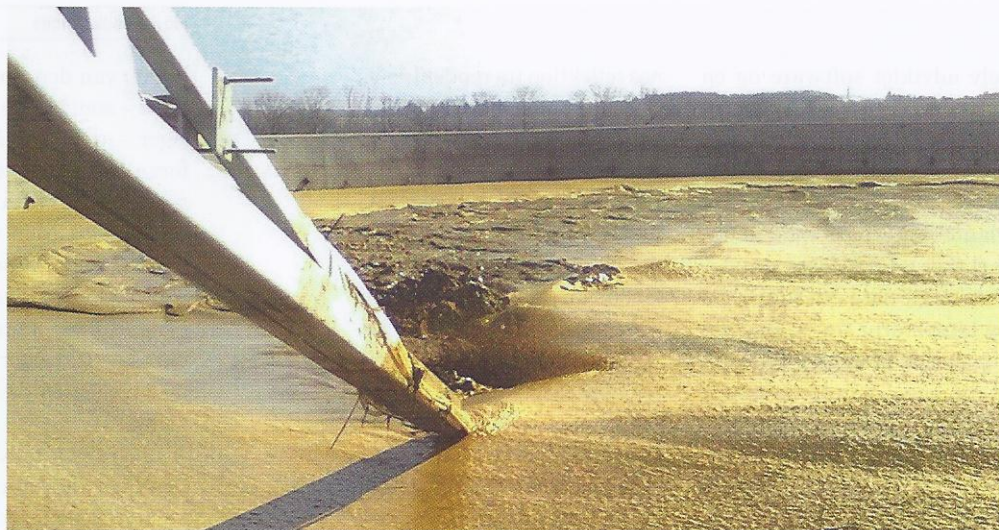
Ved tankforsuring pumpes svovlsyre ned i gyllen under omrøring. Foto: Ørum Smeden.
