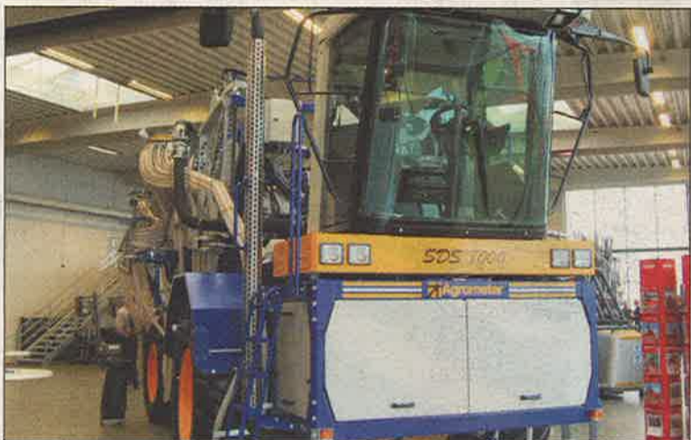
Den selvkørende gylleudlægger har fået større kapacitet i kraft af større slanger på maskinen og en større fødeledning.
