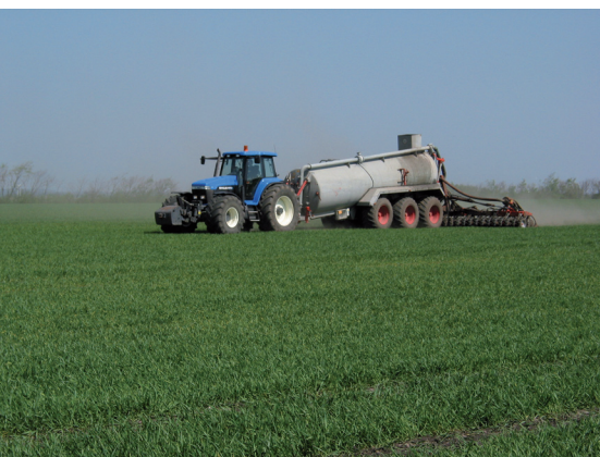
Nedfældning af gylle er en effektiv men dyr måde at reducere ammoniakfordampning og lugt i vintersæd. Foto: Torkild Birkmose, AgroTech.
