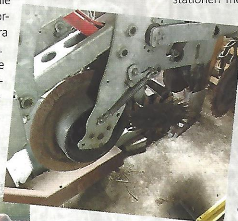
Den ene af ejerne fortalte bl.a. at Vogelsang X-Till's bærehjul synker i pløjet jord. Det fungerer til gengæld fint uden pløjning i forbindelse med Strip-Till systemer. Billedet th. viser bærehjulet på en Vogelsang X-Till maskine.
