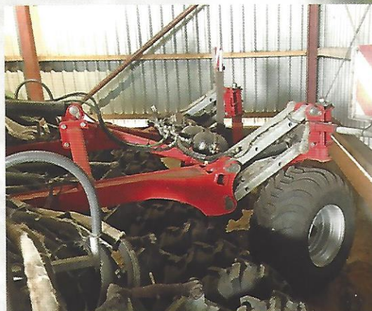
IFTen på den gamle gyllevogn kunne ikke holde til nedfælderens vægt. En 6 m/8 rk. nedfælder vejer 4,5 ton med "bærehjul".
