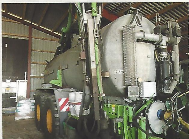
IFTen på den gamle gyllevogn kunne ikke holde til nedfælderens vægt. En 6 m/8 rk. nedfælder vejer 4,5 ton med "bærehjul".
