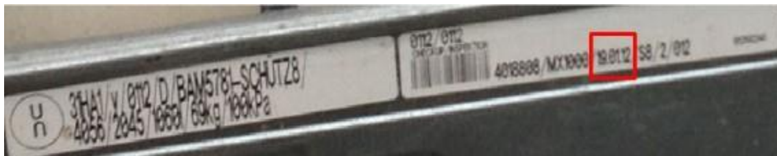
Billede 2. Aflæsning af fremstillingsdatoen på svovlsyretanken.
