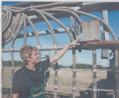
- Der er kun få ændringer på gyllevognen. En af dem er en sensor, som måler den aktuelle pH-værdi i gyllen, forklarer traktorpilott Kristian Hjorth.
