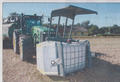
Fronttanken rummer 1000 liter og transporteres på traktorens frontlift.
